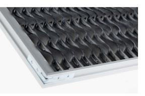
Speziell zugeschnittene Profile werden auf Maß geliefert. Die Montage des Rahmens ist sehr einfach. Die Profile werden mit Hilfe von angepassten Ecken aneinander befestigt. Die Anker werden in die äußeren Schlitze geschoben. Einbaurahmen sind in Aluminium oder Messing verfügbar.
