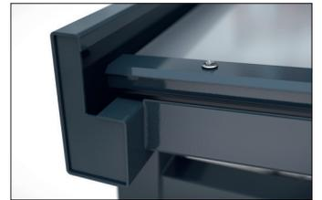
Typengeprüftes, vielseitiges Überdachungssystem mit Quadratrohrstützen und eleganter Pultdachkonstruktion, Wasserkasten aus mehrfach gekantetem und ausgesteiftem Stahlblech und integrierter Regenrinne. Die Dacheindeckung erfolgt mit einer Verbundsicherheitsverglasung (VSG) in Milchglasoptik nach DIN 18008. Die gesamte Stahlkonstruktion ist feuerverzinkt und mit
