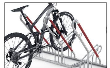
Auffälliges Detail an diesem Fahrradparksystem sind die mit signalrotem Kunststoff ummantelten schrägen Anlehnbügel. Sie schützen jedes Fahrrad oder E-Bike gegen mutwilliges oder versehentliches Umdrücken und Folgeschäden an den Felgen. Integrierte Stahl-Rundösen sorgen für optimierten Diebstahlschutz. Der Bügelabstand ist großzügig bemessen und eignet sich für Fahrräder mit Reifenbreiten bis 55 mm. Der Radabstand
