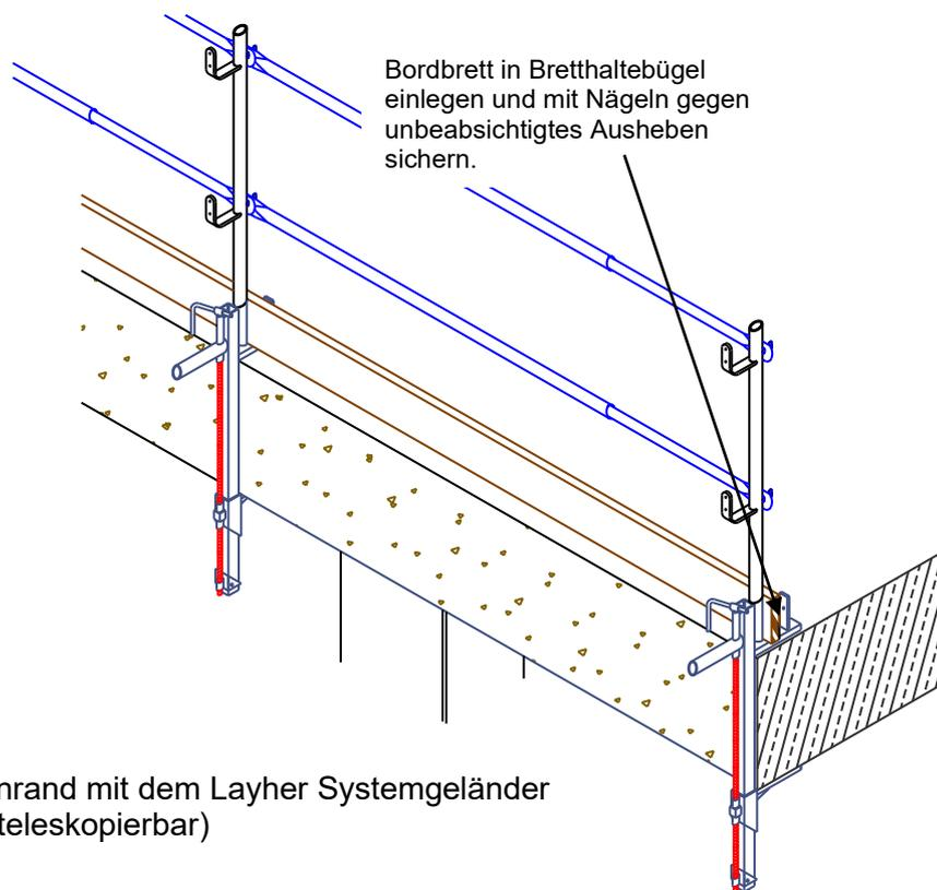
Bild: Am freien Deckenrand mit dem Layher Systemgeländer (Geländerholme teleskopierbar)
