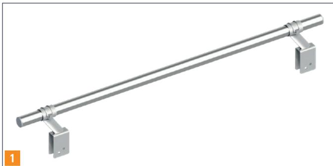
Im ersten Schritt erfolgt die Vormontage des Handlaufs. Die beiden Rohrverschlusskappen 6 werden auf das Handlaufrohr 1 aufgesteckt. Die beiden Halter 3 werden nun auf das Handlaufrohr 1 aufgeschoben und jeweils mittels Rohrklappstecker 2 in den Bohrungen im Handlaufrohr 1 gesichert.
